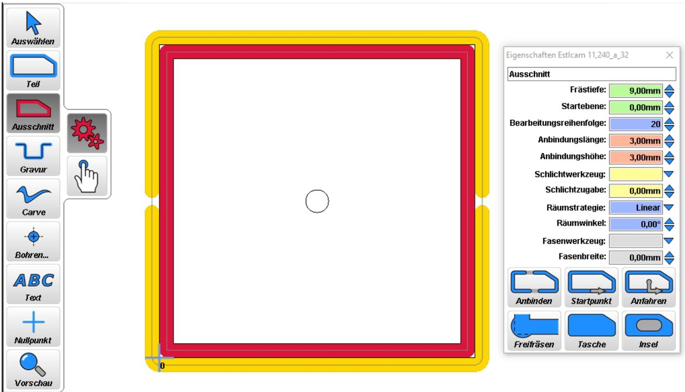
☐Merke: ESTLcam stellt ausgewählte Fräsbahnen in rot, nicht ausgewählte in anderen Farben, je nach Fräsbahntiefe dar. Somit sind alle Fräsbahnen, die die gleiche Tiefe haben auch in der gleichen Farbe dargestellt. Das kann mal gelb, mal blau in unterschiedlichen Farbschattierungen sein. Die ausgewählte Fräsbahn ist jedoch immer rot.
