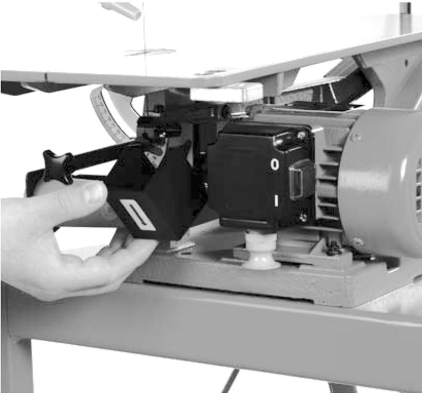
Sägeblatt aus der **Maschine** nehmen
