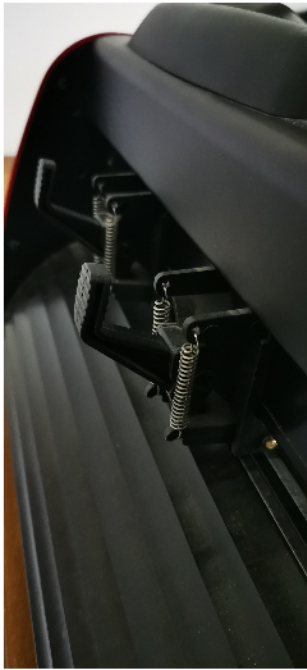
1. Andruckrollen mittels Hebel auf der Rückseite lösen
