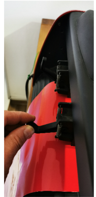
4. Andruckrollen mittels Hebel auf der Rückseite fixieren
