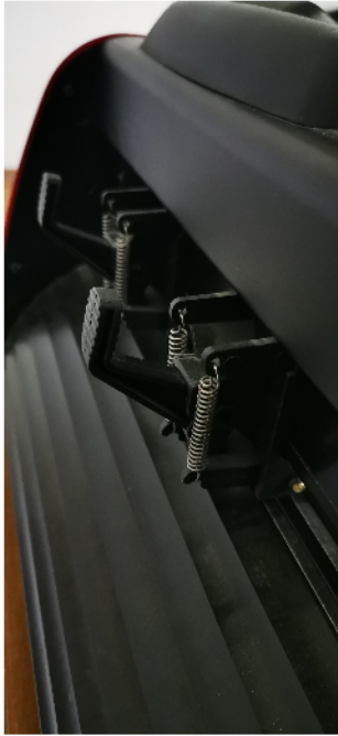
1. Andruckrollen mittels Hebel auf der Rückseite lösen
