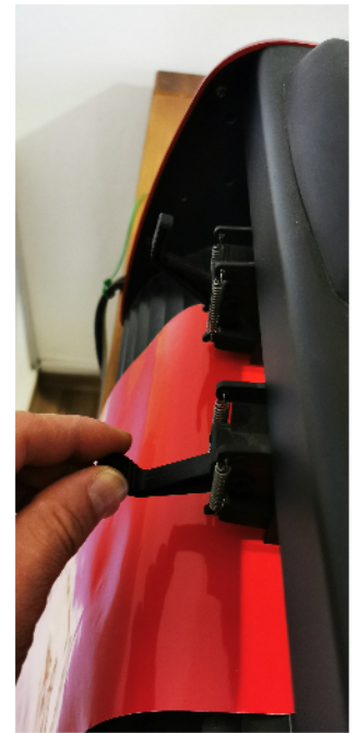
4. Andruckrollen mittels Hebel auf der Rückseite fixieren
